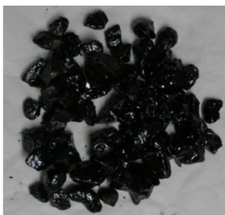
Bitumen + 0.1 wt % organosilane
